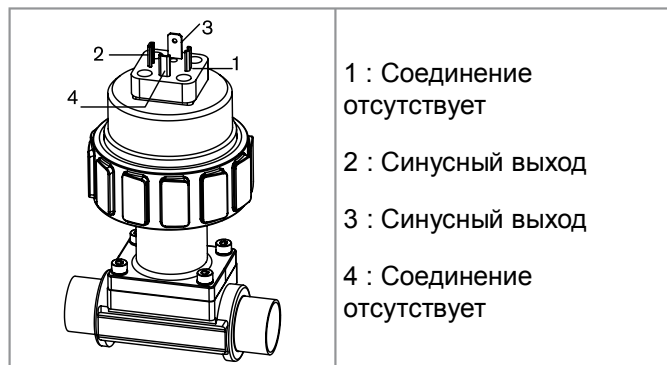
Рис. 9: Адресация клемм фиксированного разъема для синусного исполнения
