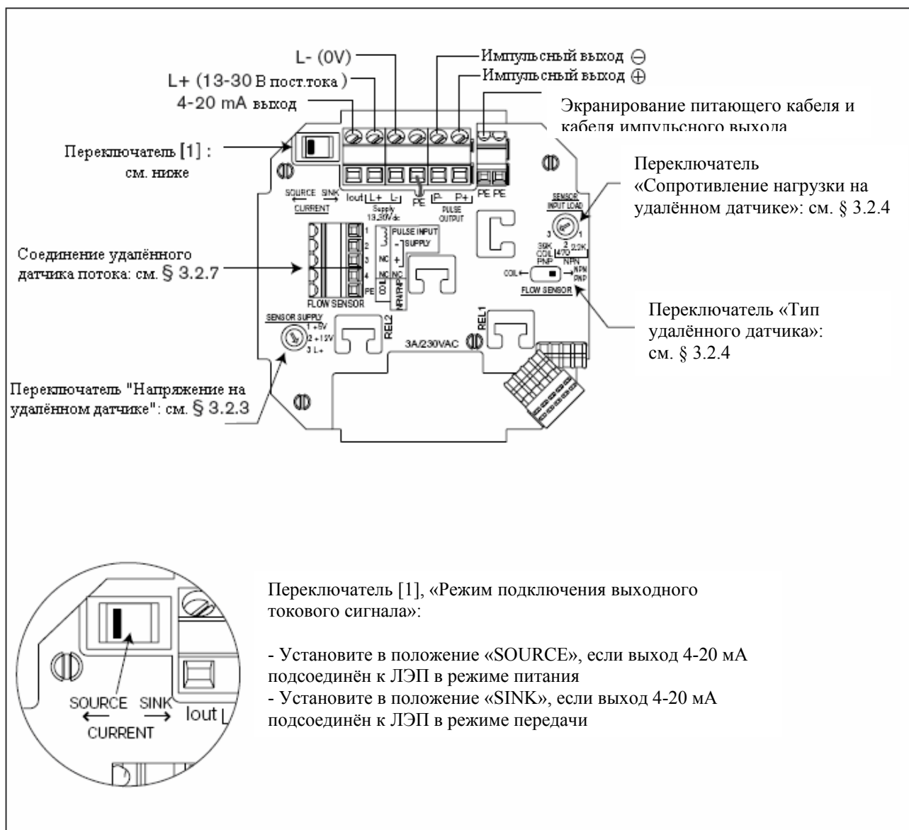
Сх. 3.4 Электроподключение датчика 8025 Универсал, щитовая версия, 13-30 В=, без реле
