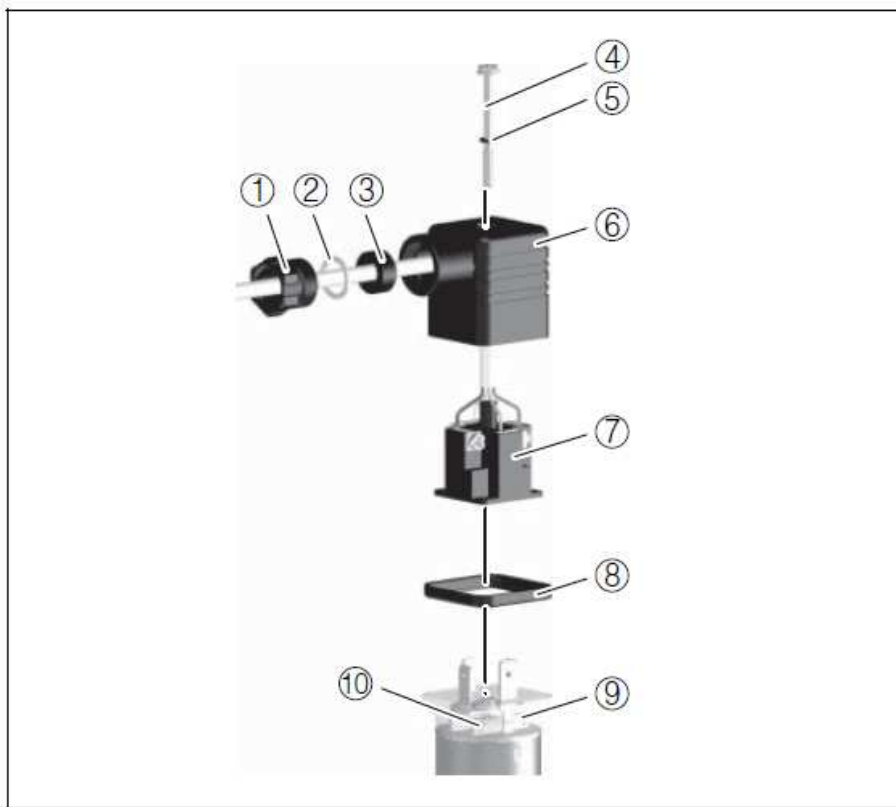
Рис. 8 Подключение с помощью разъема клапана по DIN 43650
