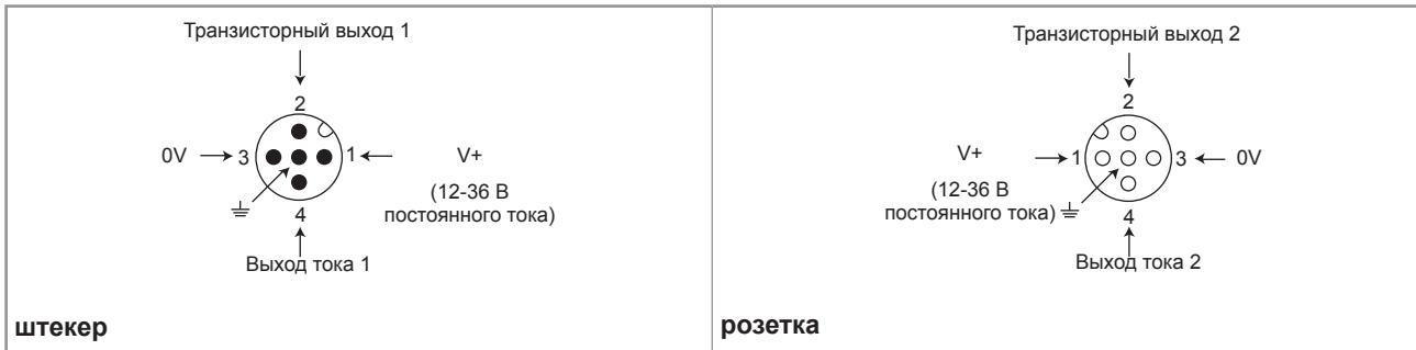
Рис. 26 Разводка контактов штекера и розетки M12
