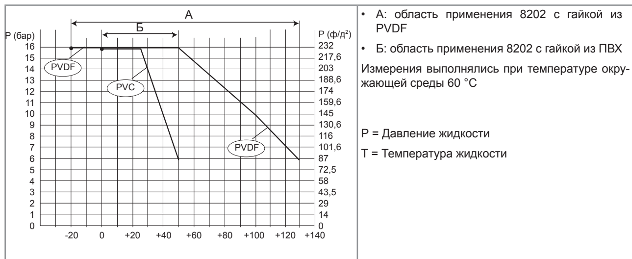
Рис. 2 Зависимость температуры/давления жидкости при использовании 8202 (без электрода) с гайкой из ПВХ или PVDF
