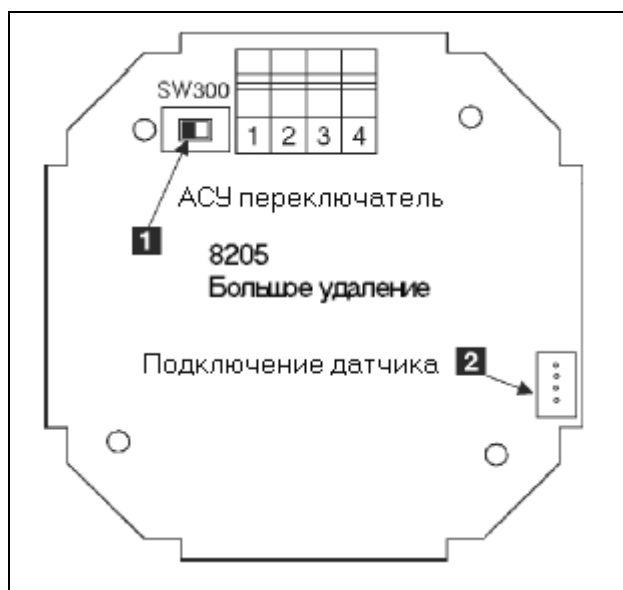
Рис. 3.20 Электронная плата датчика 8205 без реле – большое удаление
