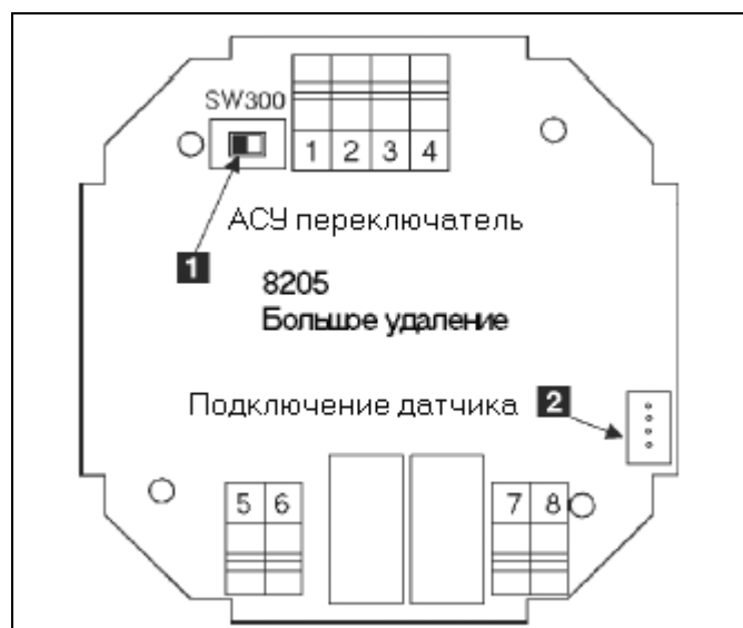
Рис 3.21 Электронная плата 8205 с реле – большое удаление
