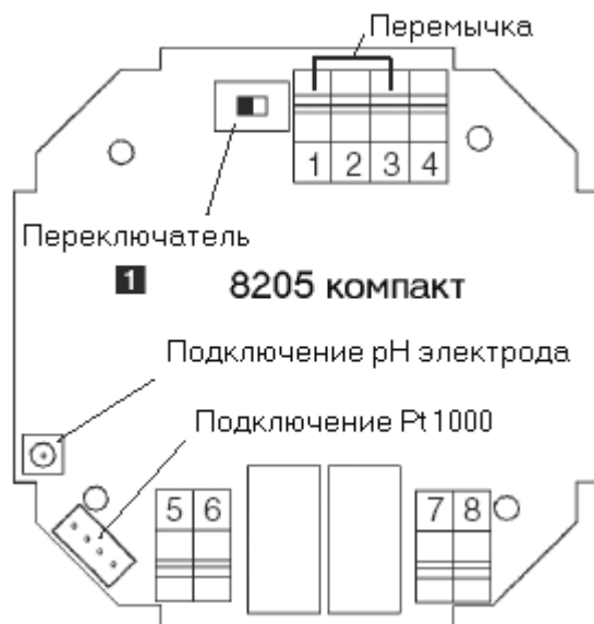
Рис. 3.6 Подключение компактного датчика 8205 с реле
