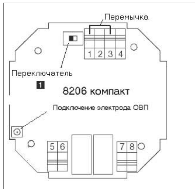
Рис. 3.6 Подключение компактного датчика 8206 с реле
