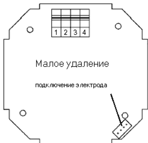
Рис. 3.7 Трансмиттер 8225 без реле, малое удаление
